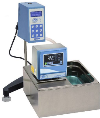
Utilisation d'un thermostat DIGITERM pour contrôler la température en mesure de viscosité au moyen de la re-circulation du liquide.
