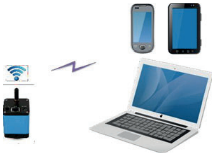
Figure 4 Le PC ou l'appareil mobile se connecte à la caméra en mode WiFi AP.
