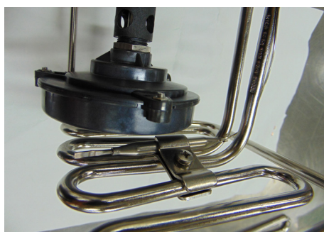
7.6b Bulbo del termostato para trabajos a temperaturas por encima de los 120°C
