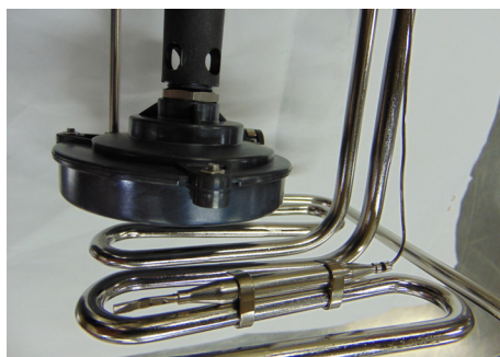
7.6a Bulbo del termostato para trabajos a temperaturas por debajo de los 120°C
