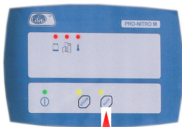
Adición manual del NaOH durante la destilación
