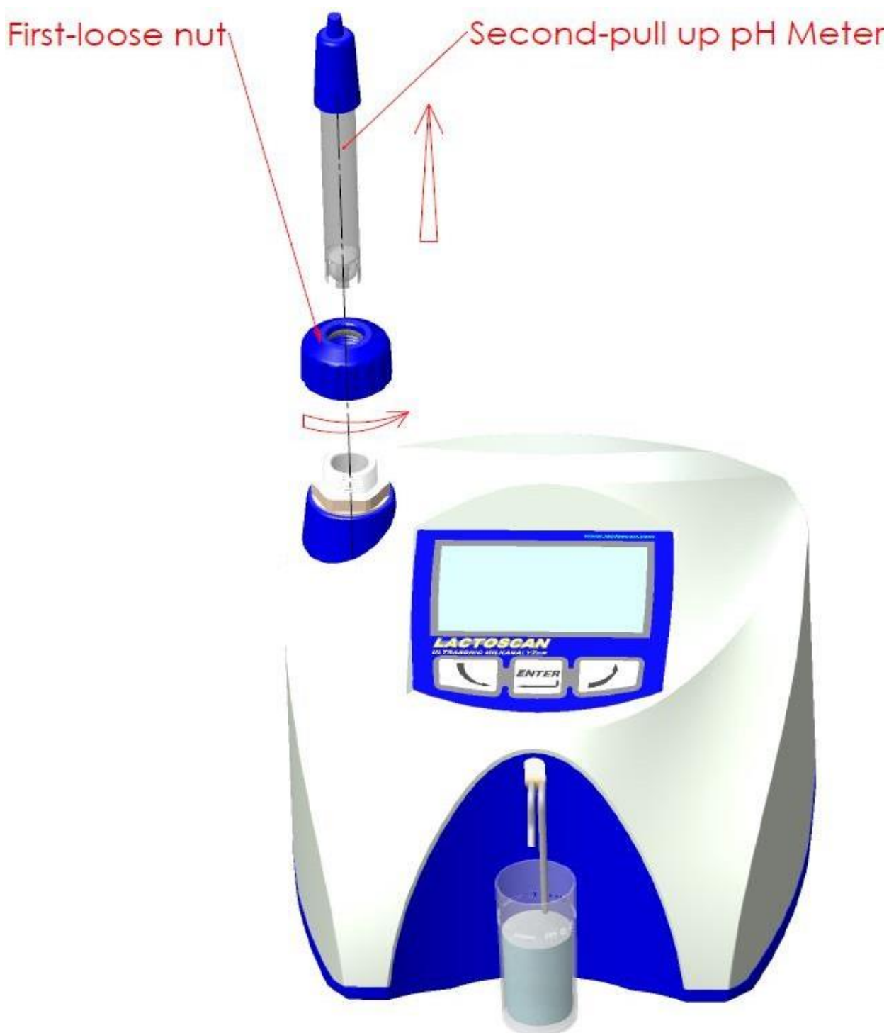
Fig. 8 Mise en place de la sonde
