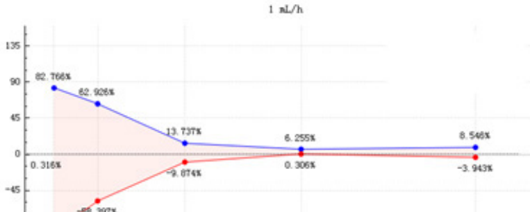
Graphique 3 Courbe de trompette : Pourcentage de variation E_p en fonction de la durée de la fenêtre d'observation P (min) et du pourcentage d'erreur moyen global A tracé à partir des données recueillies au cours de la deuxième heure de la période d'essai.
