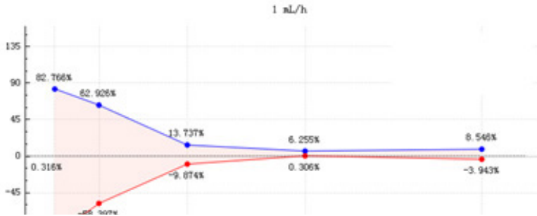
Gráfico 3: Curva de trompeta: Variación porcentual E_p frente a la duración de la ventana de observación P (min) y el error porcentual medio global A trazado a partir de los datos recogidos durante la segunda hora del período de prueba.
