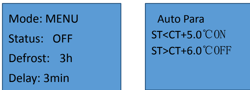
Figura 2.3.a - Pantalla de configuración de enfriamiento
