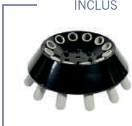
Rotor angulaire | GBK016 12×15 mL 4000 rpm / 2250 ×g
