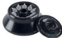
Rotor angulaire | GLK018 5 mL×10 13500 tr/min/12920 ×g
