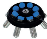
Angle rotor | GNP034 50 mL×8 6000 rpm / 5150 ×g
