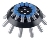
Cabezal angular | GLK041 15 mL×12 6000 rpm / 5350 ×g
