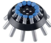
Angle rotor | GLK030 15 mL×12 6000 rpm / 5150 ×g
