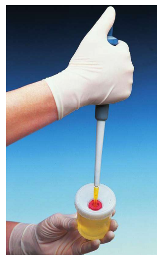
Dosificación por medio de pipeta automática o convencional.
