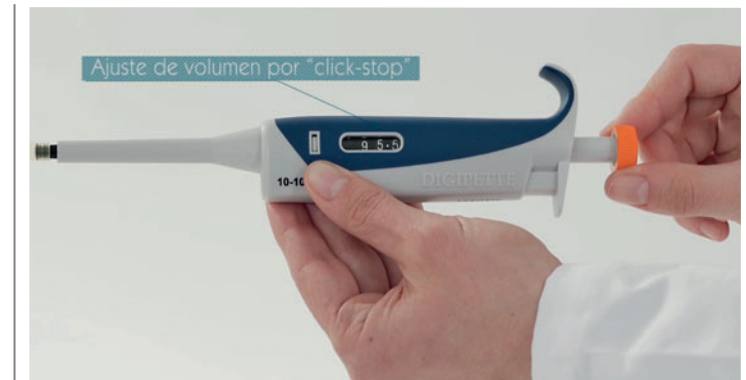
Selección del volumen mediante mecanismo “click-stop”
