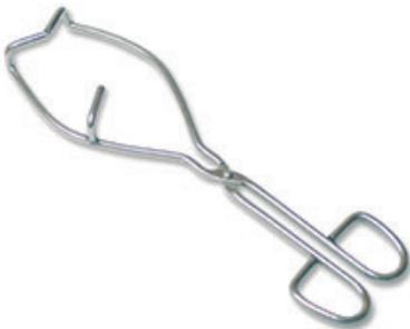
Especialmente diseñadas para asir y transportar cápsulas de porcelana u otros recipientes de fondo plano (cajas Petri, cristalizadores...), que han sido sometidos a altas temperaturas facilitando su extracción de estufas u hornos. Fabricadas en acero inoxidable.
