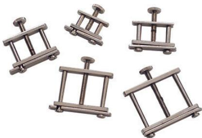
Fabricadas en metal niquelado presentan un tornillo compresor y una base con dos posiciones (abierta o cerrada). Para comprimir tubos de látex y así regular el flujo de líquido o gas.
