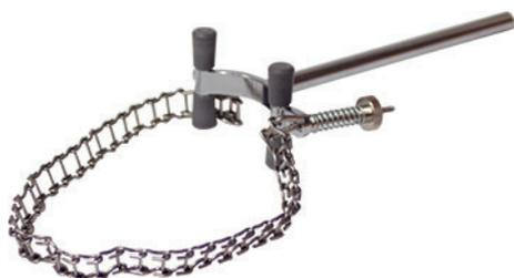
En acero inoxidable con cadena y pinza muelle, permite sujetar con seguridad recipientes de grandes diámetros.
