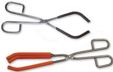
Permiten sujetar y transportar con seguridad vasos de precipitados calentados a elevadas temperaturas o que contienen sustancias peligrosas. Fabricadas en acero cromado, presentan las puntas plastificadas con PVC para evitar resbalones del recipiente que se está manejando.
