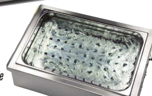
Détail de l'agitation par pompe de circulation interne.
