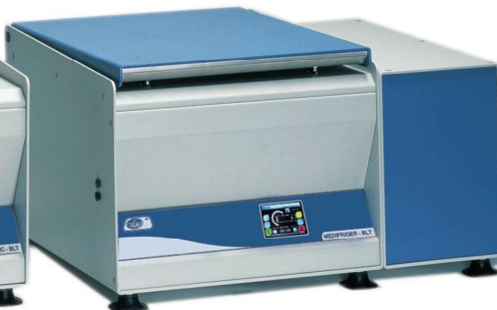
Modelo "Medifriger-BLT" refrigerada con selector de temperatura regulable de -12 a 40 °C.
