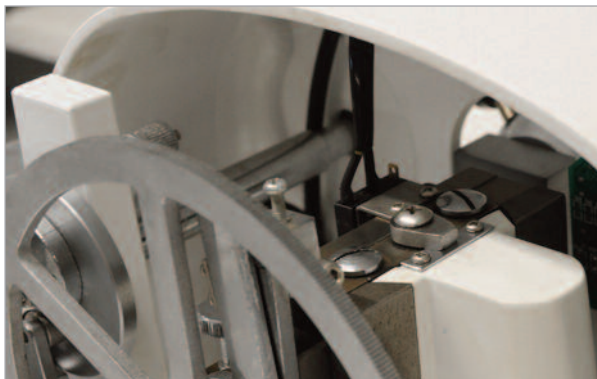
02_ Système de blocage du mécanisme intérieur qui permet de placer le bras porte-échantillons en position limite supérieur
