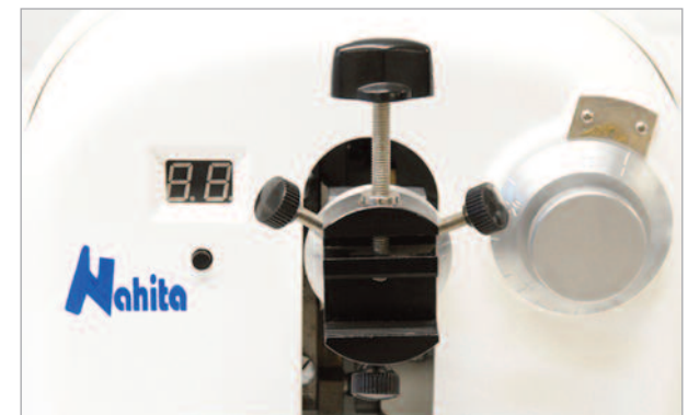
03_ Pince pour échantillons avec système d'orientation et Ecran LED qui affiche le décompte des coupes réalisées
