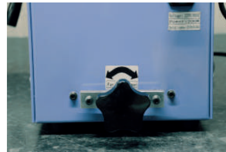
[Mécanisme de réglage] Mécanisme de réglage de la distance et de la coup, permet aux lames de se déplacer en avant et en arrière.
