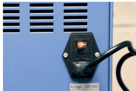
[Interrupteur général] Permet d'éteindre l'appareil rapidement et en toute sécurité.
