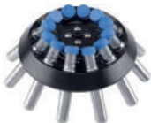
Angular rotor | GLK041 15 mL×12 6000rpm/5350×g
