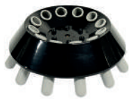
Angular rotor | GBK016 12x15 mL 4000rpm / 2250 xg
